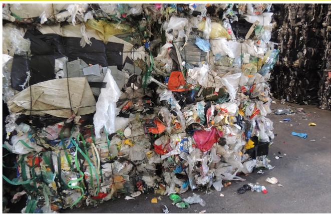
Das **restliche Material** (kleine und verschmutzte Verpackungen und Fehlwürfe) wird **verpresst**. Der hohe Energiegehalt des Materials wird in speziellen Verbrennungsanlagen **zur Erzeugung von Strom oder Wärme** genutzt.
